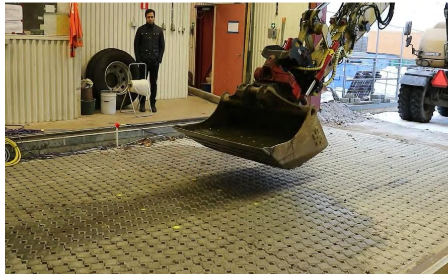
Víz beszivárgás vizsgálata 200 liter/2sec
